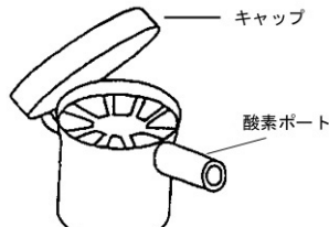
図2 SSVO スピーキングバルブ 酸素ポート付 (底辺内径 15mm)
