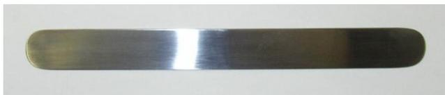
2.原材料:ステンレス鋼 SUS420
