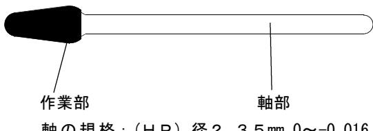
軸の規格 : (HP) 径 2.35 mm 0~-0.016
