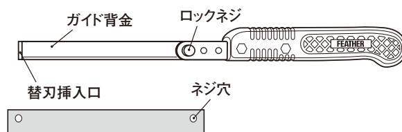
1. ロックネジをゆるめ、替刃を替刃插入口から刃先を損傷しない様、ガイド背金にそって、替刃がとまるところまで入れる。
