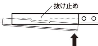
※替刃を取り替える場合、替刃の先端部を下方にずらし、抜け止めから替刃がはずれたことを確認の上で、ゆっくりと抜き取る。
