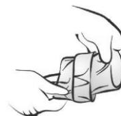
4. プローブカバー開口部を引っ張るようになし、プローブ及びケーブルをプローブカバーで覆い、ゴムバンドでプローブカバーを固定して下さい。
