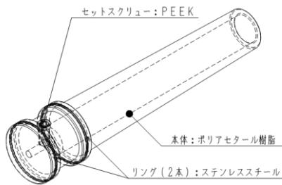
材質:ステンレス鋼、アセタール樹脂、PEEK樹脂
