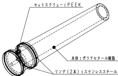
原材料: ステンレス鋼、アセタール樹脂、PEEK
