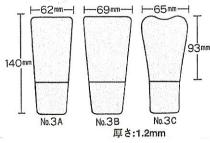
2)材質・組成 ステンレス SUS 3 0 4 板材を研磨した片面鏡。
