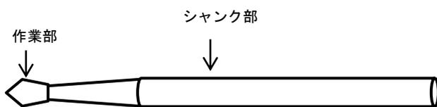
シャンク部(軸部)の外径: 1.6mm
