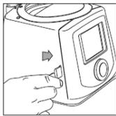
スマートスティックポートの挿入孔の形状に合わせてスマートスティックを挿入し、音がするまでスマートスティックを押し込む。
