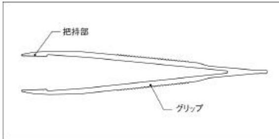
・本品は、電子線滅菌又はエチレンオキサイドガス滅菌を施した、ディスポーザブルなプラスチック製の鑷子です。
