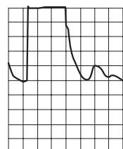
オーバーダンピングシステム—— アキュダイナミックの設定が高すぎる。
