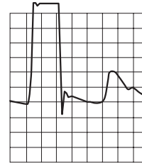
最適なダンピングシステム—— 正しく設定されたアキュダイナミック
