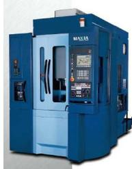
メインスピンドルに回転運動を与えて、直線軸および傾斜軸と回転軸（傾斜軸と回転軸はオプション）の CNC 制御により材料と軸状ツールを接触させて切削加工を行う機器。
