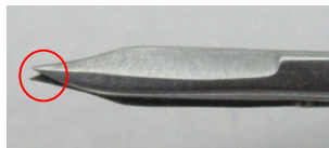
破損状態① (先端部の交差)
