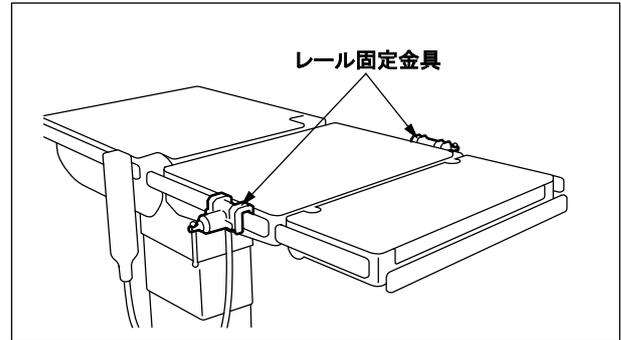
1. 手術台左右のサイドレールにレール固定金具を取り付けます。
