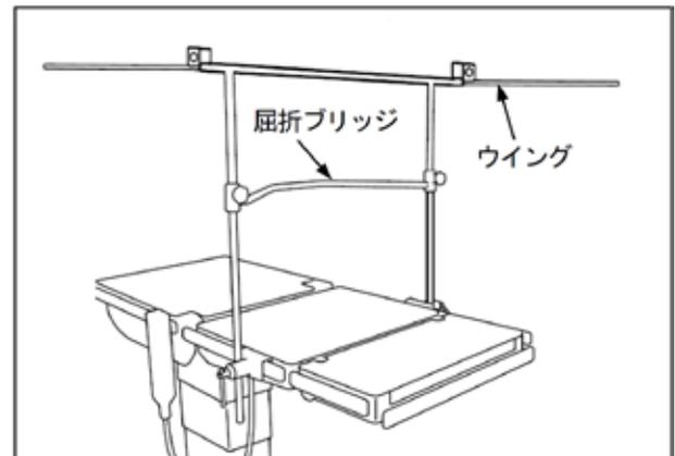
2. ウイングを開き、必要に応じて屈折ブリッジの高さを調整後、レール固定金具に支柱を差し込み、固定ハンドルで調整・固定します。
