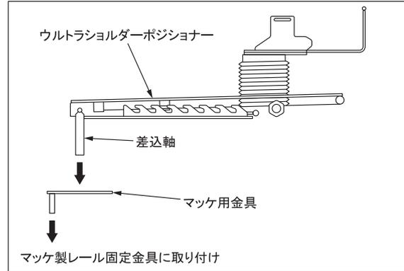
1-1 ウルtrasholderポジショナーの差込軸を、マッケ用金具の溝に取り付けます。
