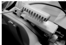
図 9：カセットの取り付け
