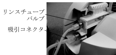
図 12：バイオブシープローブのチューブをカセットのコネクタ/バルブに接続
