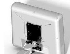
図 2：タッチスクリーンの本体への取り付け
