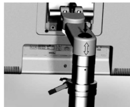
図 5：タッチスクリーンの高さ調整
