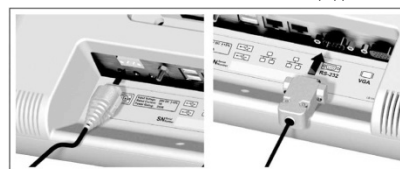
図 3：タッチスクリーンへのケーブル類の接続
