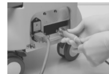
図 2: フットペダル接続部
