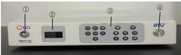
①内視鏡接続コネクタ ②ディスプレイ ③コントロールキー／ファンクションキー ④スタンバイ／ワーキングモード切替ボタン
