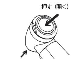
② 上記①の状態のまま指で切削工具を回し、チャック奥の半月溝と切削工具後端をはめ合わせる。このとき溝と工具後端がはめ合わないと工具は固定されないので、挿し込んで止まる位置から、さらに一段奥へ押し込むこと。
