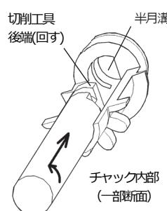
(4) コントラシャンクをマイクロモーターの接続筒に挿し込み、接続する。カチッと音がするまで、まっすぐ奥に押し込んでロックさせること。
