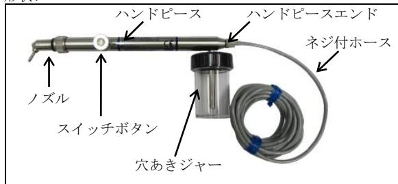
原理: 本品は受動型機器であり、歯科用ユニットや本品専用マイクロエッチ・ブローフ等により供給されるエア一源により、専用ジャーに充填された粉末を噴射する。
