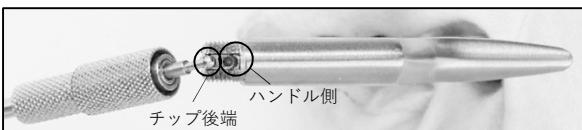
ハンドルを開放し、先端部を矢印の方向にねじ込む事で固定する。なお、取り外しの際は上記手順を逆から実施する。
