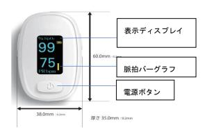
測定値が見やすいように体の位置により横向き表示になる。 脈波波形は横向きディスプレイに表示される。
