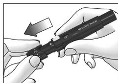
1) 採血用穿刺器具(以下、穿刺器具)の本体キャップを引っ張って外します。
