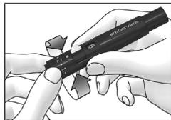
1) 深さ調節ダイヤルを回して、穿刺の深さを調節します。穿刺設定目安を参照してください。
