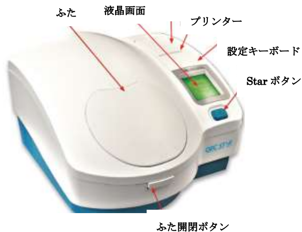
図 1 : QBC STAR 血球計数装置
