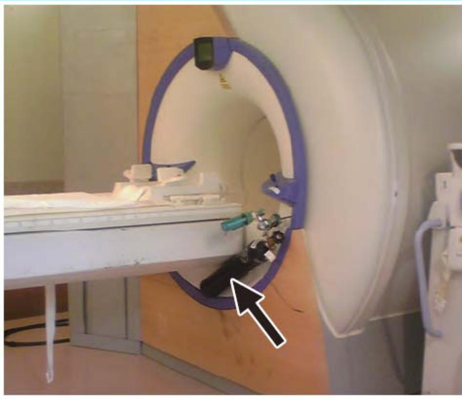
MRI装置に清掃器材が吸着した事例
