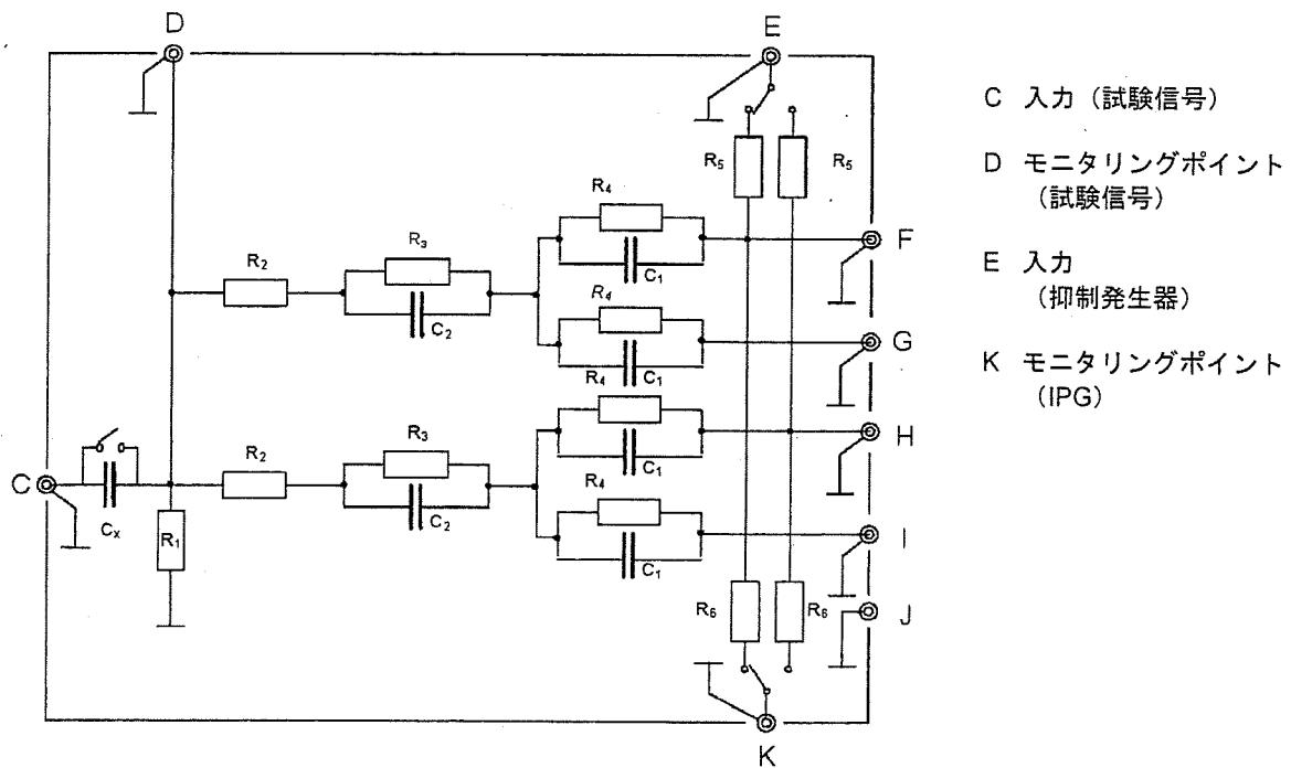
図 G.102 - 機能不良を検査するための組織等価インターフェース回路
