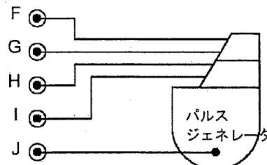
図 142 - マルチチャネル双極パルスジェネレータへのコモンモード接続
