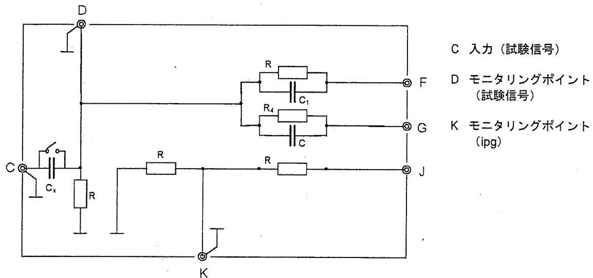
図 G.101 - 電流測定のための組織等価インターフェース回路
