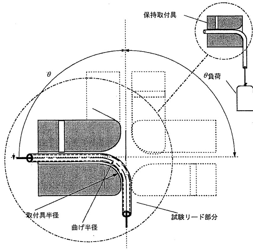
図 127 - 導線曲げ試験取付具
