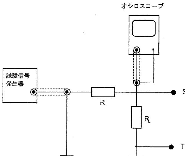
図 150 - 静磁場測定のための試験設定
