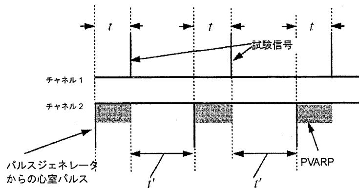
図 118 - PVARP 測定時のオシロスコープ表示
