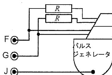
図 135 - マルチチャネル双極パルスジェネレータへのコモンモード接続
