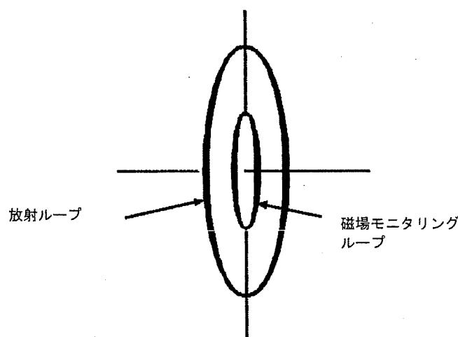
図 151 - 磁場可変試験のためのループ構成
