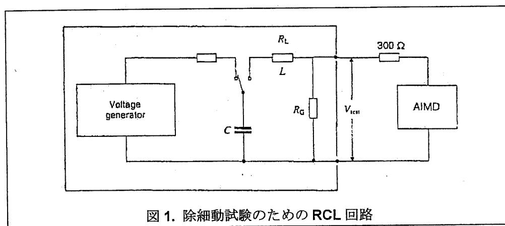
図1. 除細動試験のためのRCL回路
