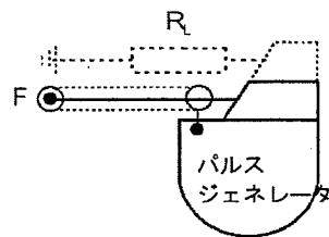
図 148 - 単極パルスジェネレータへの接続
