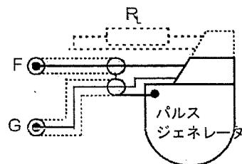
図 149 - 双極パルスジェネレータへの接続
