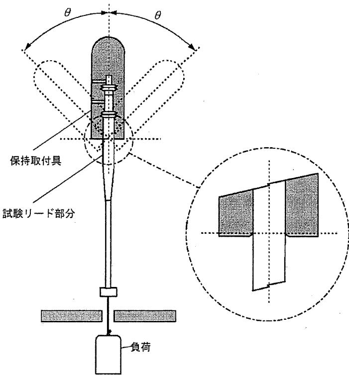
図 128 - コネクタ曲げ試験取付具
