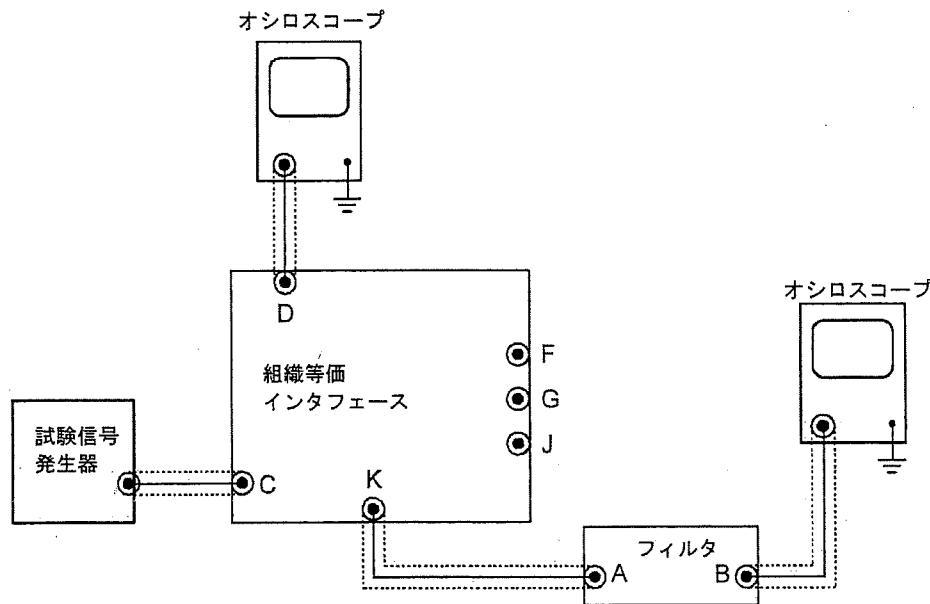
図 130 - 誘導電流測定のための試験設定
