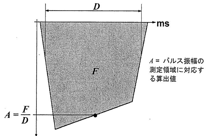
図 F.102 - パルス振幅の測定
