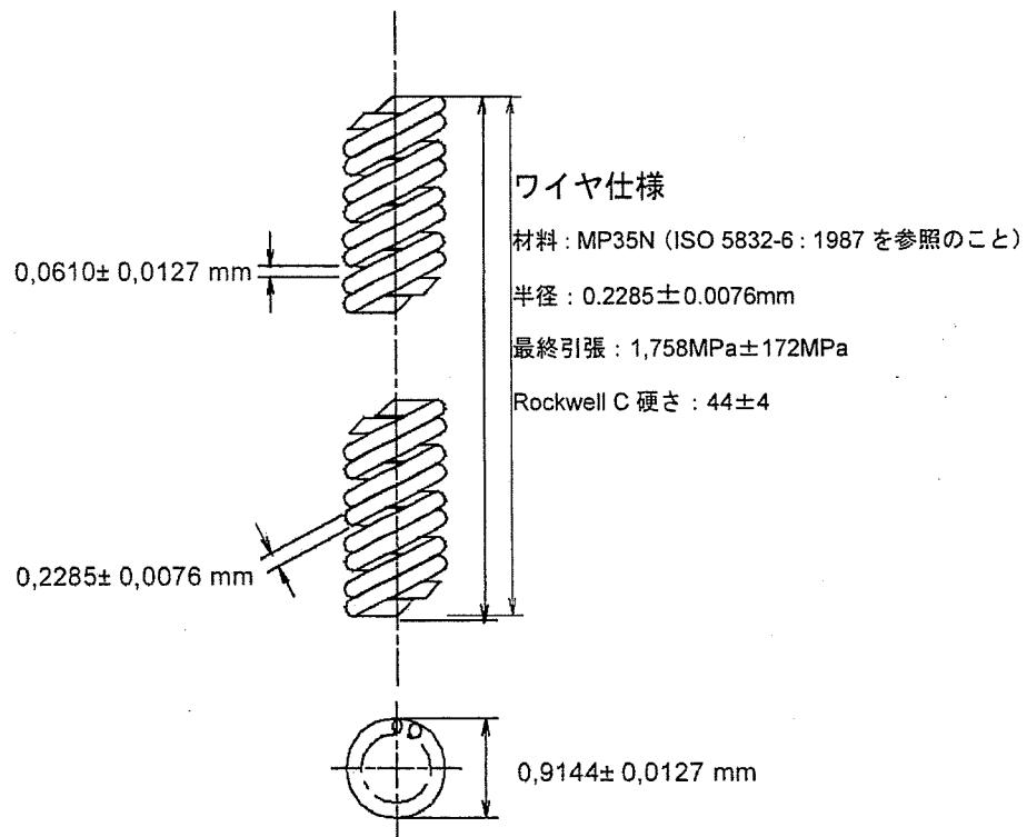
図 C.102 - 基準試験コイル
