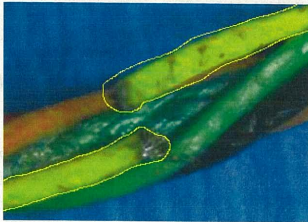
図 13：内部導線の断線
