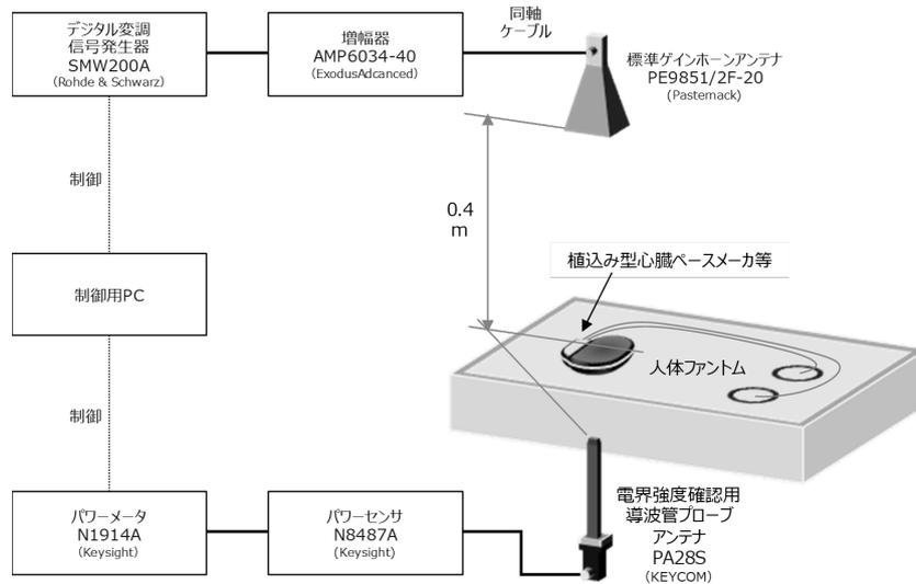
図 1-4 28GHz 帯の模擬システムの構成概要
