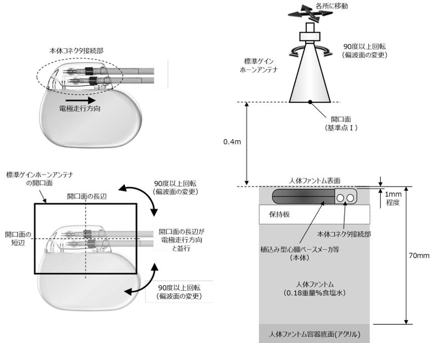
図 1-17 アンテナの角度、基準点の概要図
