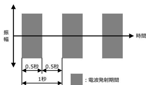
図 2-3 影響測定での電波の断続発射状態
