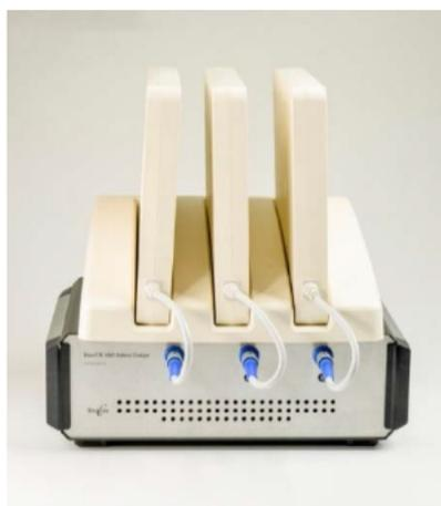
図 5 バッテリーラック及びバッテリー充電器 (バッテリー収納時)
