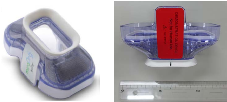
図3 バイオチップの外観（ハンドピースに装着し、皮膚を吸着するために使用）
