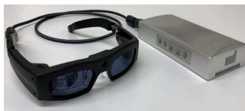
制御ボックスの寸法 : 160 mm×80 mm×31 mm
