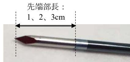
アクティブ電極（電極先端部）
