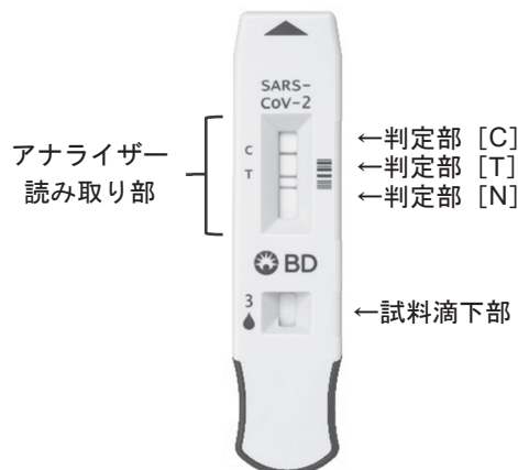
図1 テストプレート各部の名称
