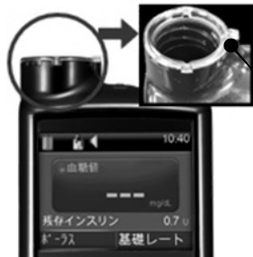
リテーナ リザーバ挿入部先端にあるリング状の部品
