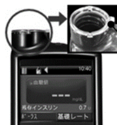
リテーナ リザーバ挿入部先端にあるリング状の部品
